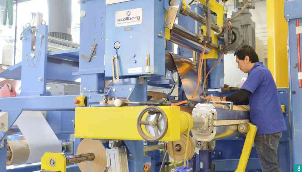
Herstellung einer Sekundärwicklung. (Quelle: Rauscher &amp; Stoecklin)
